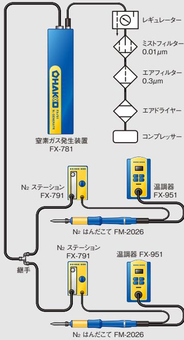
例) 供給空気圧0.5MPaの時、97%の窒素濃度で約1L/min.供給することが可能です。
