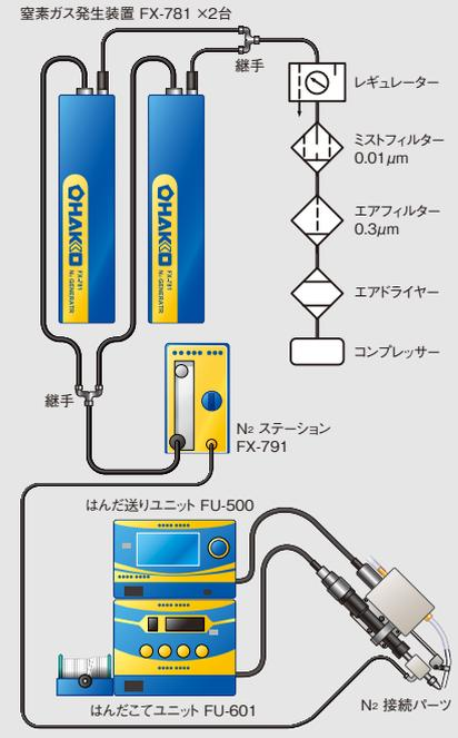
例) 最大供給空気圧0.7MPaの時、最大99.9%の窒素濃度で約2L/min.供給することが可能です。
