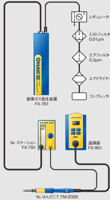
例) 最大供給空気圧0.7MPaの時、最大99.9%の窒素濃度で約1L/min.供給することが可能です。
