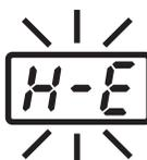
Se a temperatura da ponta cair abaixo do limite de alarme de temperatura baixa, **H-E** será exibido e um sinal sonoro soará.
