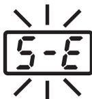
Quando houver a possibilidade de que ocorreu uma falha no sensor ou no aquecedor (incluindo o circuito do sensor), **S-E** será exibido e um sinal sonoro soará.
