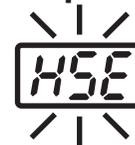
**HSE** será exibido e um sinal sonoro soará quando a ponta estiver inserida incorretamente, uma ponta incompatível estiver inserida ou quando um objeto estranho penetrou no conector.
