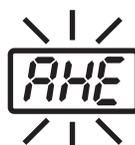
Quando a temperatura da ponta exceder o ajuste de temperatura mais 50°C e esse estado de alta temperatura durar 10 segundos ou mais, o ferro de solda será imediatamente desenergizado e **AHE** será exibido e um alarme sonoro soará.
