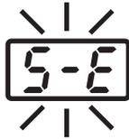
Este erro ocorre quando existe a possibilidade de falha no sensor (ou no circuito do sensor).
