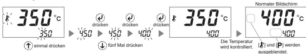
Sobald der normale Bildschirm angezeigt wird, drücken Sie die Taste [TEMP], um in den Modus Voreingestellte Temperatur zu wechseln.
