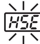
**HSE** wird angezeigt, und ein Signalton ertönt, wenn die Spitze falsch eingesetzt wird, wenn eine inkompatible Spitze eingesetzt wird, oder wenn ein Fremdkörper in den Anschluss eingedrungen ist.
