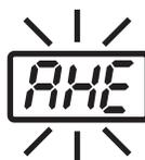
Wenn die Temperatur der Lötspitze die eingestellte Temperatur plus 50°C überschreitet und dieser hohe Temperaturzustand 10 Sekunden oder länger anhält, wird der Lötkolben sofort stromlos geschaltet und **AHE** wird angezeigt und ein Signalton ertönt.
