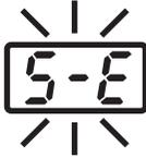
Wenn die Möglichkeit besteht, dass ein Fehler im Sensor oder der Heizung aufgetreten ist (einschließlich Sensorschaltkreis), wird **S-E** angezeigt, und ein Signalton ertönt.
