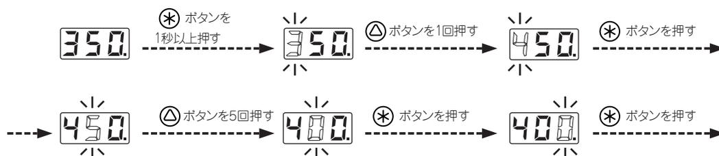
これで内部メモリーに記憶され、新しい設定温度を表示後、ヒーター制御を始めます。
