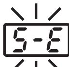
Este erro ocorre quando existe a possibilidade de falha no sensor (ou no circuito do sensor).
