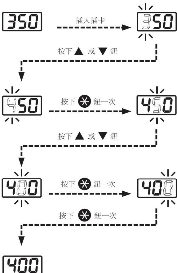
**當控制臺為 ON 而插卡在控制臺時，數值輸入程序如下：**
