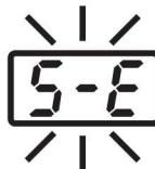
如有是傳感器 / 發熱元件（含傳感器電路）任何部份失靈時，會顯示錯誤標記 **S-E**，輸送到焊鐵之電流被停頓。
