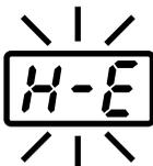
Si la température du détecteur tombe en dessous de la différence entre le réglage de la température courante et la tolérance d'alarme de basse température, le message **H-E** est affiché et le signal avertisseur sonne. Si la température de la pointe s'élève à une valeur comprise dans la plage de tolérance, l'avertisseur arrête de sonner.
