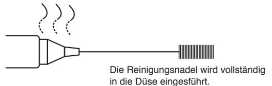
Reinigen mit dem Reinigungsbohrer
