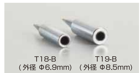
こて先の外観、デザイン、内部構造を見直すことで熱伝導率を高めた「T18 シリーズ」「T19 シリーズ」を採用。こて先の外形、及び内部の厚みに差をつけることで T19 の蓄熱がアップし、熱容量が必要な作業もできるようになりました。
