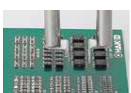
こて先の外観、デザイン、内部構造を見直すことで熱伝導率を高めた「T18 シリーズ」「T19 シリーズ」を採用。こて先の外形、及び内部の厚みに差をつけることで T19 の蓄熱がアップし、熱容量が必要な作業もできるようになりました。
