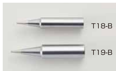
こて先の外観、デザイン、内部構造を見直すことで熱伝導率を高めた「T18 シリーズ」「T19 シリーズ」を採用。こて先の外形、及び内部の厚みに差をつけることで T19 の蓄熱がアップし、熱容量が必要な作業もできるようになりました。
