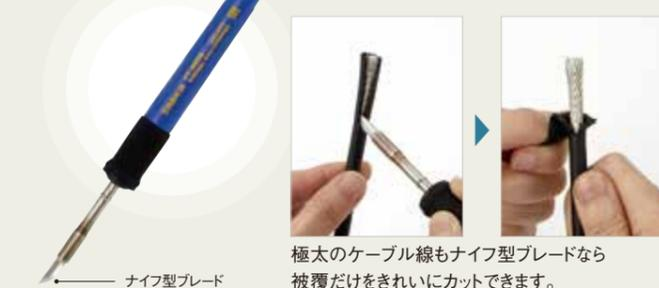
極太のケーブル線もナイフ型ブレードなら被覆だけをきれいにカットできます。
