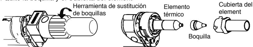
Se debe quitar la cubierta del elemento y la boquilla con la herramienta que se adjunta.
