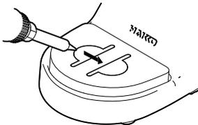
Verwenden Sie den Reinigungsschwamm, der im Lieferumfang enthalten ist, um die Lötspitze zu reinigen. Sie können ihn sowohl zum Abstreifen überflüssigen Lotes verwenden, als auch zum vollständigen Entfernen von Oxidationsprodukten.
