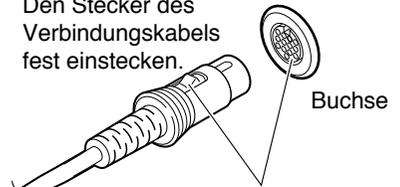
Stecken Sie den Stecker so weit wie möglich in die Buchse; versuchen Sie ihn wieder auszuziehen ohne die Klinkentaste zu drücken; nur wenn sich der Stecker so nicht trennen lässt, ist er richtig eingerastet und ordnungsgemäß verbunden.
