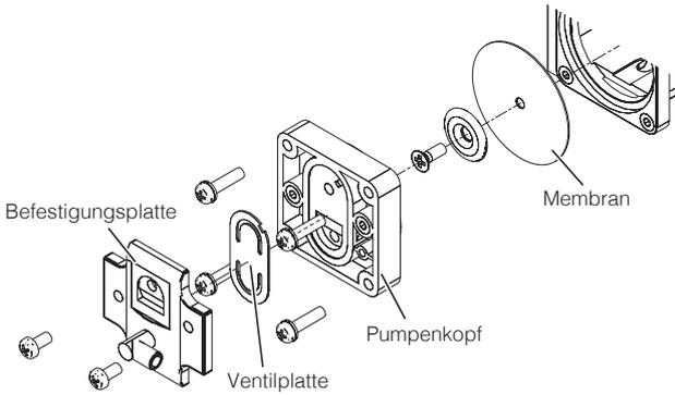
3. Reinigen Sie die Düsenplatte, die Befestigungsplatte und den Pumpenkopf mit Isopropylalkohol.
