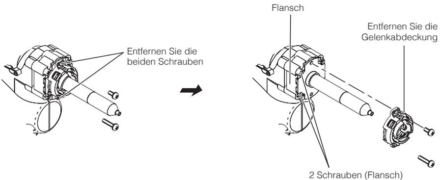
2. Lösen Sie die Schraube an der Rückseite der Pumpenabdeckung und entfernen Sie die Abdeckung.
