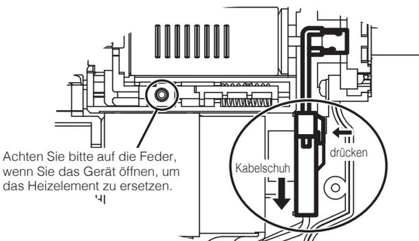
Stellen Sie bitte sicher, dass nach dem Ersetzen des Heizelementes die Düsentemperatur kalibriert wird. Sollten Sie dies versäumen, kann es zu einer höheren oder niedrigeren Temperatur des Heizelementes kommen, was wiederum die Oxidation und/oder Abnutzung der Entlötdüse beschleunigt, und auch zu einem verfrühten Verschleiß des Heizelementes beiträgt.
