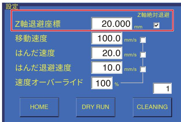
基板等のはんだ付け周辺部の危険、不意の破損を防ぐための機能の一つにZ軸退避があります。Z軸退避座標は、水平移動でワークの突起物への接触を防ぐために設定する座標です。これはプログラム実行およびマニュアルでJOG運転をしている時のいずれでも動作します。
