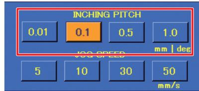
1. トップ画面の **INCHING PITCH** (0.01 mm/deg、0.1 mm/deg、0.5 mm/deg、1.0 mm/deg) から任意の値を選択します。
