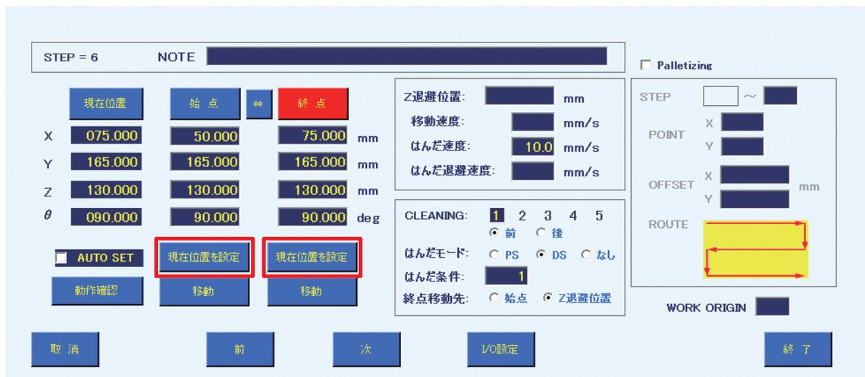
11. CLEANING 番号およびクリーニングを行うタイミングを「PS (ポイントはんだ付け) の設定」の場合と同様に選択します。DS (引きはんだ付け) も6ポイント目のクリーニングをはんだ付け前に設定します (上の画面参照)。
