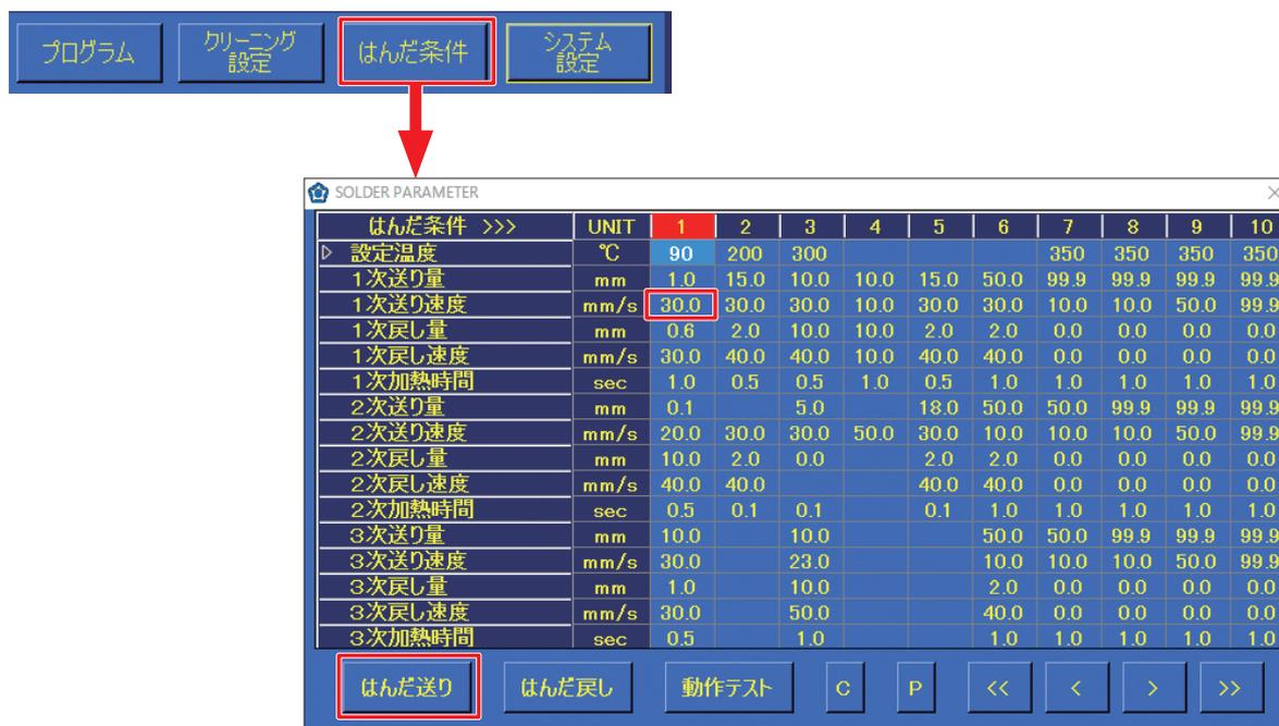
4. はんだ送りパラメータ設定画面もしくはトップ画面の【はんだ送り】をタップすると、はんだが送られます。もう一度タップするとはんだ送りが停止します。フッ素樹脂チューブの先端からはんだが出てくるまではんだを送ってください。
