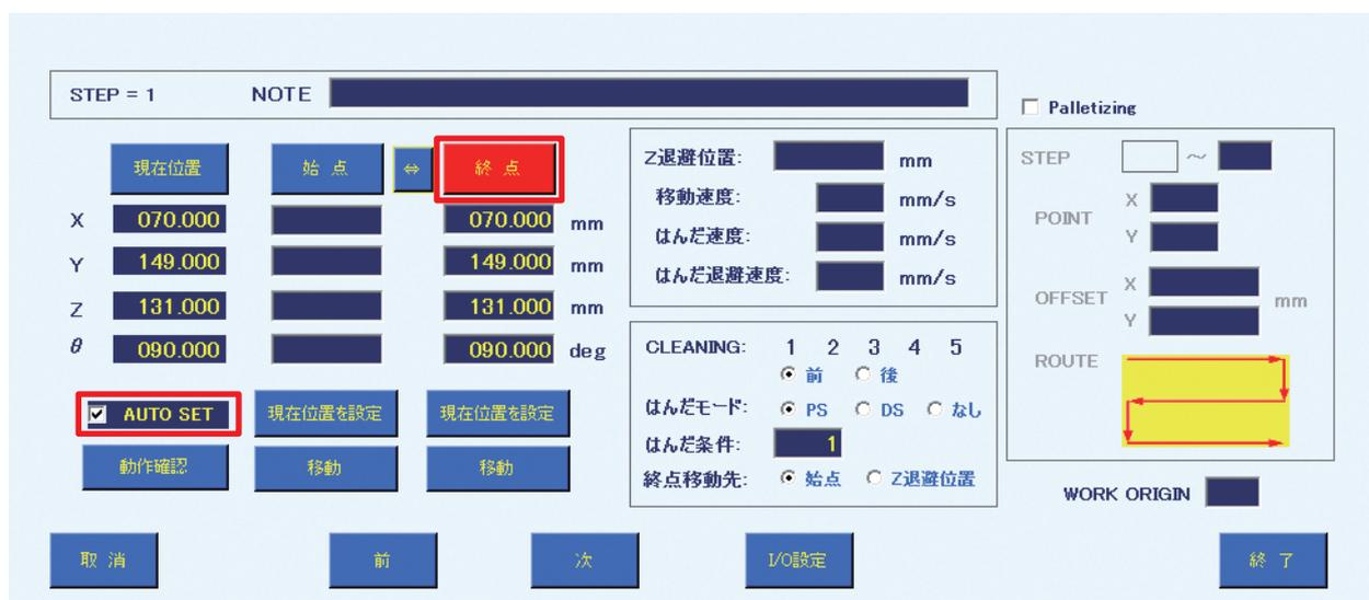
3. ロボットの [Easy Input Switch] ボタンを押すと、手順 2 の操作で位置決めした座標の終点座標への入力が入力完了します。
