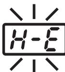
センサー検出温度が設定温度と下限設定温度との差以上に大きくなった場合、**H-E** が表示されブザーが鳴ります。こて先温度が設定温度範囲内に上昇すれば、ブザーは鳴り止みます。
