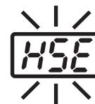
こて先が間違った方向に挿入されたり、使えないこて先が挿入されたり、コネクタとの接続部に異物が混入したりしていると**HSE** が表示されブザーが鳴ります。
