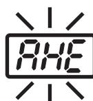
こて先温度が設定温度+50°Cを超え、その状態が10秒以上継続した場合、こてへの通電を即座に停止し**AHE**を表示。ブザーが鳴ります。
