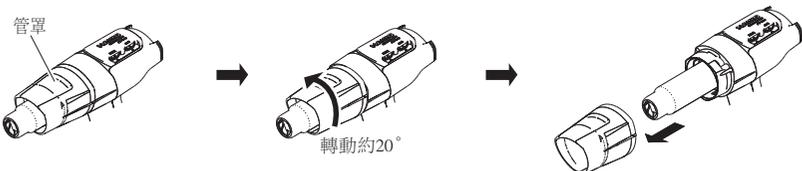
2. 擰下固定保護管的4個螺絲拆下保護管 (+雲母)。
