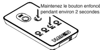
3. Lorsque le réglage de canal est terminé, la DEL de l'unité principale clignote deux fois et le signal sonore se déclenche le même nombre de fois que le canal sélectionné.
