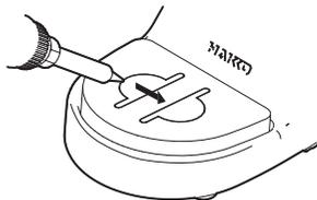
可用配套的清淨海綿擦拭焊鐵頭。輕輕擦拭焊鐵頭，也可以用來清除氧化物，用途廣泛。
