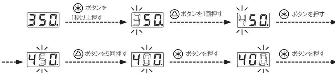
これで内部メモリーに記憶され、新しい設定温度を表示後、ヒーター制御を始めます。
