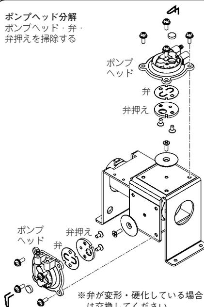
2. 弁・弁押えを取付ける。
