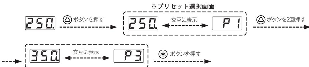
これで新しいプリセット温度でヒーター制御を始めます。
