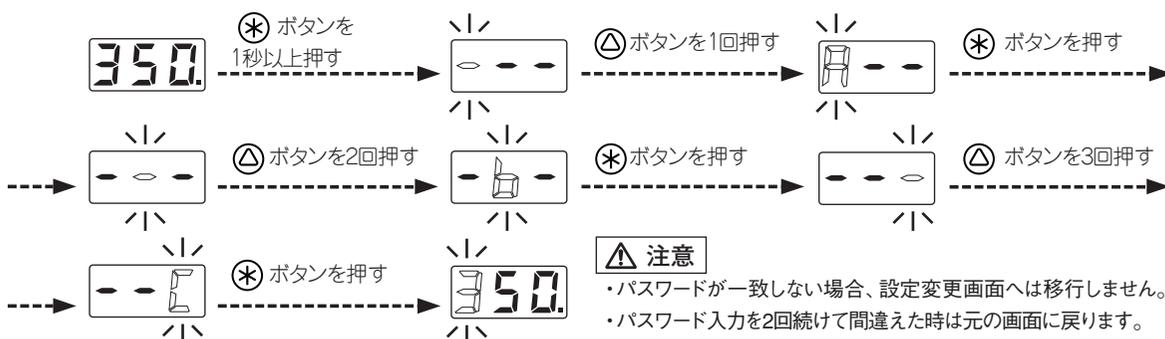
パスワード入力後、各モードの設定変更画面へ移行します。以降は各モードの設定手順に従って変更を行なってください。
