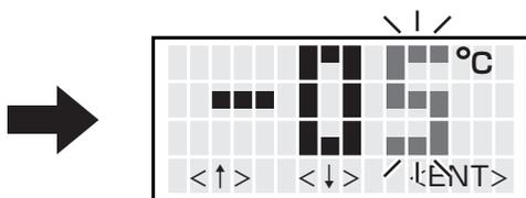
3. 1桁目の設定変更が終了した後、<ENT>ボタンを押すことで数値が内部に記憶され、新しいオフセット値でヒーター制御を始めます。
