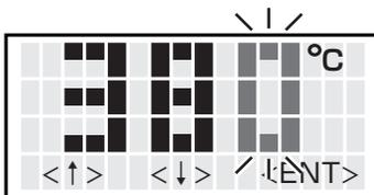
3. 1桁目の入力後、<ENT>ボタンを押すと数値が内部メモリに記憶され、新しい設定温度の表示後にヒーター制御を始めます。
