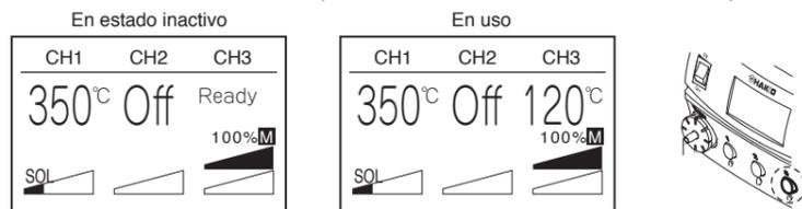
El soldador de manode aire caliente tiene un modo manual y un modo automático. Los ajustes que pueden realizarse en cada modo son distintos.
