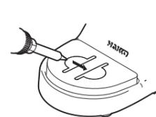
Utiliser l'éponge de nettoyage fournie avec le produit pour nettoyer la panne. Elle peut être utilisée à diverses fins, de la simple élimination de la soudure en excédent à l'élimination complète des résidus résultant de l'oxydation.
