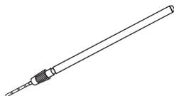
Broca de limpeza  $\varnothing 1,0\text{mm}$
