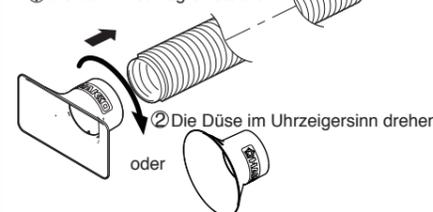
② Die Düse im Uhrzeigersinn drehen
