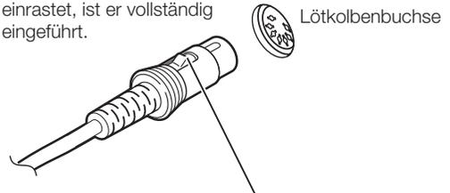
Stecken Sie den Stecker so weit wie möglich in die Buchse; versuchen Sie ihn wieder ausziehen ohne die Klinkentaste zu drücken; nur wenn sich der Stecker so nicht trennen läßt, ist er richtig eingerastet und ordnungsgemäß verbunden.
