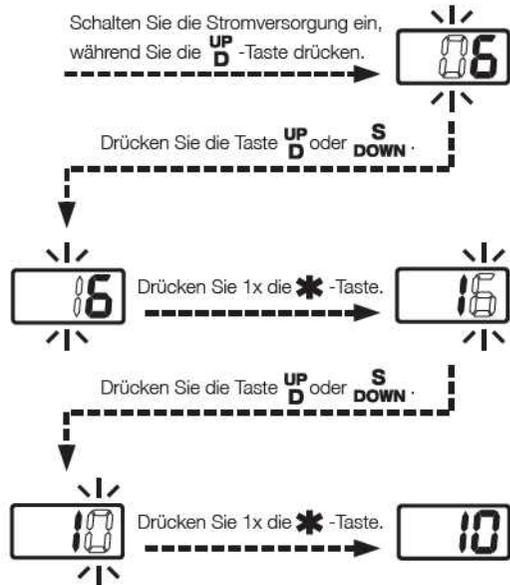
Die Einstellungen für Kanal D sind, wie im vorhergehenden Diagramm gezeigt, abgeschlossen. Durch nochmaliges Drücken der Taste **\*** gelangt man zu den Einstellungen für den Kanal S. (Der Ablauf ist der gleiche wie bei Kanal D.)
