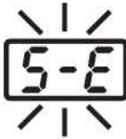
Wenn ein Fehler im Heizkreis oder im Temperaturfühler auftritt, wird **S-E** angezeigt und der Heizkreis schaltet sich aus.
