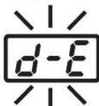
An der Anzeige erscheint **d-E**, wenn der Strom eingeschaltet wird, nachdem das MODELL FM-2022/2023 mit einer heißen Lötspitze angeschlossen wurde.
