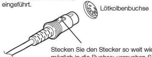
Stecken Sie den Stecker so weit wie möglich in die Buchse; versuchen Sie ihn wieder ausziehen ohne die Klinkentaste zu drücken; nur wenn sich der Stecker so nicht trennen läßt, ist er richtig eingesteckt und ordnungsgemäß verbunden.
