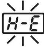
Sobald die Temperatur an der Lötspitze auf einen Wert unterhalb der eingestellten Warnschwelle abgefallen ist, zeigt die Station blinkend **H-E** an und ein Warnsignal ertönt so lange, bis die Temperatur wieder im richtigen Toleranzbereich liegt.
