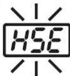
**HSE** blinkt in der Anzeige und ein Signal ertönt, wenn die Lötspitze falschherum eingesetzt wurde, oder falls eine unpassende Spitze benutzt wird oder wenn ein fremdes Objekt in die Aufnahme für die Lötspitze gerät.
