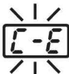
**L-E** blinkt, wenn das Anschlusskabel für den LötKolben nicht richtig eingesteckt wurde; das geschieht auch, wenn ein falscher LötKolben angeschlossen wurde.
