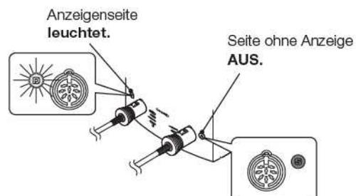
● **Wenn der LötKolben HAKKO FM 2027 oder das Entlötmodul HAKO 2024 wieder an den Anschluß des Kanal D angeschlossen wird.**
