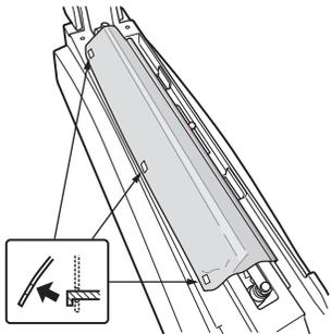
3. BOXドライバーにて、後側ヒーター端子部分を固定します。
