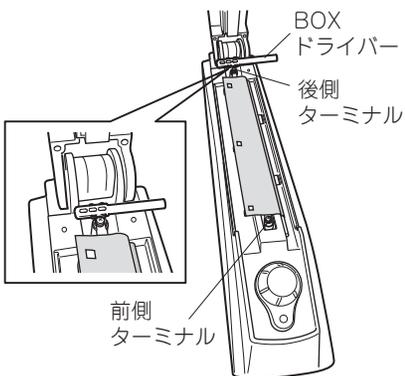
4. 前側の固定ねじを外し、次に後側の固定ねじを外してヒーターを取り外します。
