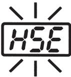
팁이 잘못된 방향으로 삽입되거나, 본 제품에서는 사용할 수 없는 팁이 삽입되거나, 커넥터와 접속부에 이물질이 들어가 있으면 **HSE**가 점멸 표시되어 경고 Buzzer가 연속해서 울립니다.
