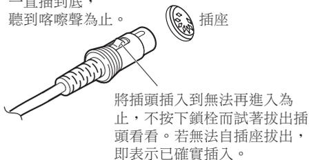
將插頭插入到無法再進入為止，不按下鎖栓而試著拔出插頭看看。若無法自插座拔出，即表示已確實插入。
