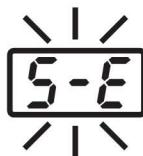
センサー／ヒーター切れ（センサー回路を含む）の可能性がある場合、**S-E** が表示され、電源が遮断されます。
