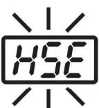
こて先が間違った方向に挿入されたり、この商品では使えないこて先が挿入されたり、コネクタとの接続部に異物が混入したりしていると、**HSE** が点滅表示され、警報ブザーが連続して鳴ります。
