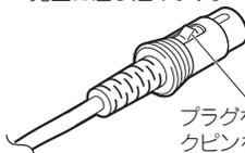
プラグを止まるまで押し込み、ロックピンを押さずにプラグを引っ張ってみてください。レセプタクルから抜けなければ、きちんと差し込まれています。
