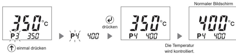
**Hinweis** Einstellungen zwischen 451°C (851°F) bis 500°C (940°F) sind nur verfügbar, wenn ein Hochleistungs-lötKolben angeschlossen ist.
