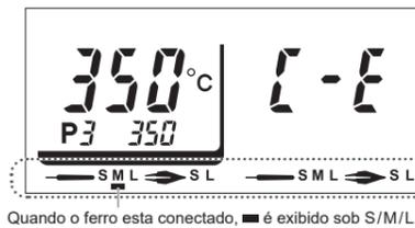
Se nenhum ferro estiver conectada a um canal, [C - E] será exibido e o alarme soará. Se o botão do canal for pressionado por 2 segundos, o visor mudará para [OFF] e o alarme será parado.
