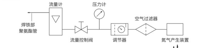
(3) 将焊铁部的聚氨酯管连接至流量计。
