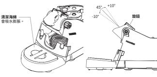
(3)將焊鐵部插入焊鐵插座中。
