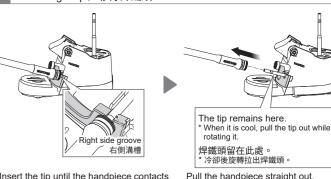
Insert the tip until the handpiece contacts the "right side groove." 插入焊鐵頭,直到焊鐵部觸及「右側溝槽」。
