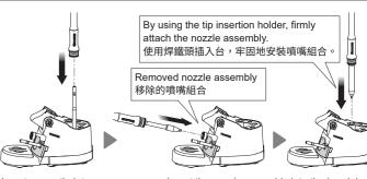
Insert a new tip into the handpiece 將新的焊鐵頭插入 煌鐵部。
