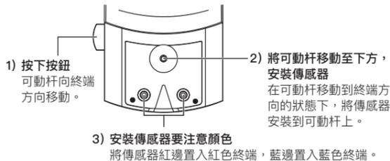
3. 傳感器安裝完畢後打開電源開關。當顯示屏顯示室溫時，溫度計便可使用。
