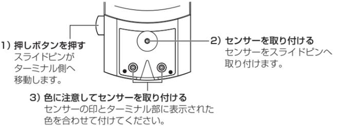
3. センサーを取り付けたら電源を入れます。室温が表示されたら測定可能です。
