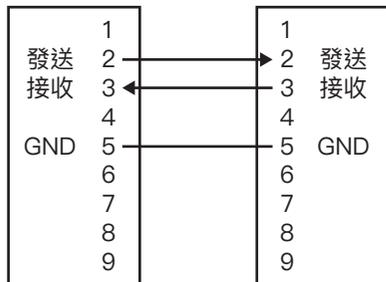
Dsub9大头针笔直結線的纜正附属于供FN-1010使用的接口卡(B5211)。附帶纜線為母-母規格。於接口卡側的2、3、5以外的針無連線，可使用全線直排接線的纜線。
