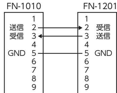
FN-1010用のインターフェースカード (B5211) にDsub9 ピンストレート結線のケーブルが付属しています。付属のケーブルはメス-メスの仕様です。インターフェースカード側にて2、3、5以外は空きピンとなっていますので、全線ストレート結線のケーブルを使用できます。
