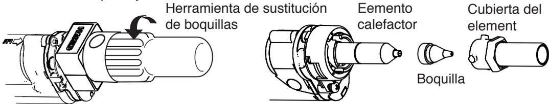
Se debe quitar la cubierta del elemento y la boquilla con la herramienta que se adjunta.
