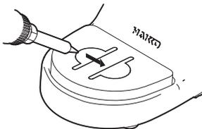
Utilice la esponja de limpieza que viene con el producto para limpiar la punta. Ofrece una amplia gama de usos, desde la simple eliminación del exceso de soldadura hasta la eliminación completa de la materia que se produce como resultado de la oxidación.
