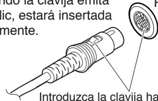
Introduzca la clavija hasta el tope e intente retirarla sin pulsar la patilla de liberación. Si ésta permanece dentro del receptáculo, estará asentada correctamente.
