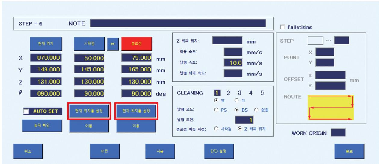
11. CLEANING 번호 및 클리닝을 실행하는 타이밍을 「PS(포인트 납땜) 설정」의 경우와 동일하게 선택합니다. DS(연속 납땜)도 여섯 번째 포인트의 클리닝을 납땜 전으로 설정합니다(위 화면 참조).
