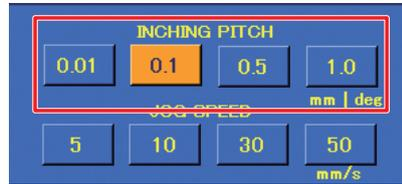
1. 톱 화면의 **INCHING PITCH** (0.01 mm/deg, 0.1 mm/deg, 0.5 mm/deg, 1.0 mm/deg) 에서 임의의 값을 선택합니다.
