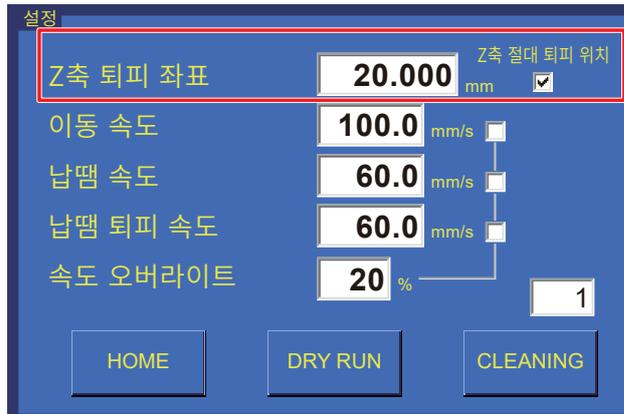
Z 축 퇴피는 기판 등의 납땜 주변부 위험, 불의의 파손을 방지하기 위한 기능 중 하나입니다. Z 축 퇴피 좌표는 수평 이동 중 워크의 돌기물에 대한 접촉을 방지하기 위해 설정하는 좌표입니다. 이것은 프로그램 운전 및 수동으로 JOG 운전을 할 때 모두 작동합니다.
