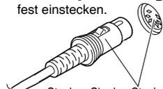
Stecken Sie den Stecker so weit wie möglich in die Buchse; versuchen Sie ihn wieder ausziehen ohne die Klinkentaste zu drücken; nur wenn sich der Stecker so nicht trennen lässt, ist er richtig eingerastet und ordnungsgemäß verbunden.
