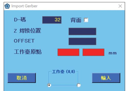
3. 背面的勾選框未勾選 (OFF) 時指定為電路板的正面，勾選中 (ON) 時指定為背面。對通孔等電路板背面進行焊接時請勾選中 (ON) 勾選框。電路板正面設置時和背面設置時的基準點 (0.0) 不同。
