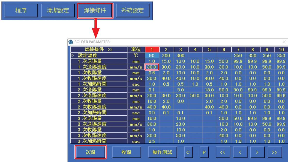
4. 點擊送錫參數設定畫面的 [送錫]，則開始送錫。再次點擊則停止送錫。請持續送錫至焊錫從氟素樹脂軟管的前端露出為止。
