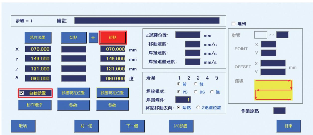
3. 按下機械人的 [Easy Input Switch] 按鈕，則將於**步驟2**的操作中定位的坐標輸入至終點坐標的操作完成。
