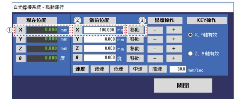
焊鐵裝置的移動，例如焊接位置的調整，在點動（JOG）運行畫面上操作。
