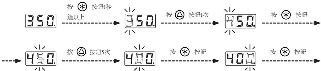
這樣，變更值就被內部存儲器記憶，顯示新的設定溫度後，開始按此設定控制發熱元件。
