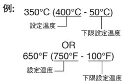
センサー検出温度が設定温度と下限設定温度との差以上に大きくなった場合に“Low Temp Error”が表示され、警報ブザーが鳴ります。ノズル温度が設定温度範囲内に上昇すれば、ブザーは鳴り止みます。
