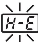
Si la temperatura de la punta cae por debajo del límite de baja temperatura de la alarma, aparece la indicación **H-E** y se dispara una alarma.
