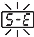
Cuando existe la posibilidad de avería en el sensor o el calentador (incluido el circuito del sensor), aparece la indicación **S-E** y la alarma se dispara.
