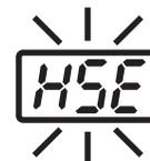
Cuando una punta insertada de manera incorrecta, una punta incompatible o un objeto extraño entran en el conector aparece la indicación **HSE**.
