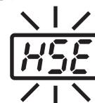
**HSE** wird angezeigt und ein Signal ertönt, wenn die Lötspitze falschherum eingesetzt wurde, oder falls eine unpassende Spitze benutzt wird oder wenn ein fremdes Objekt in die Aufnahme für die Lötspitze gerät.
