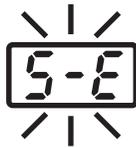
センサー／ヒーター切れ(センサー回路を含む)の可能性がある場合、**S-E**が表示されブザーが鳴ります。
