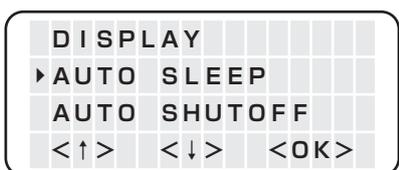
Pour déplacer le curseur, appuyer sur le bouton <↑> ou <↓>. Les éléments suivants apparaissent successivement.
