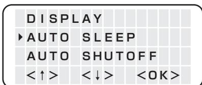
Bewegen Sie den Cursor durch Drücken der <↑> oder <↓> Taste. Die folgenden Punkte werden der Reihe nach angezeigt.
